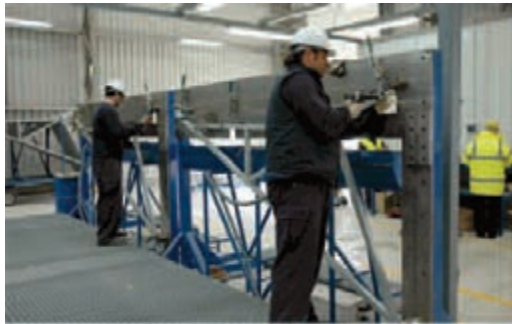
Abbildung 4 und 5 Einstellvorrichtungen (jigs) für die Serienfertigung
