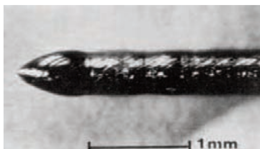
Abbildung 1 1953: Erster hoch reiner Siliziumstab der Firma Siemens, gezüchtet durch den so genannten A-Prozess
