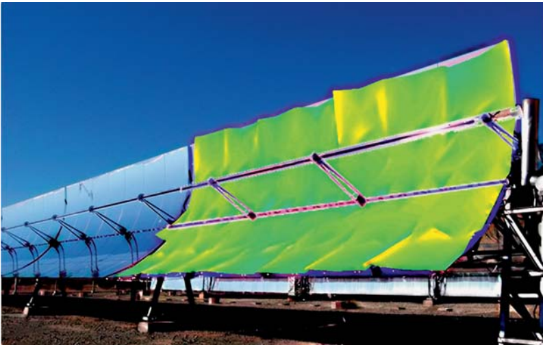
Abbildung 6 Formabweichung eines Parabolrinnenkollektors von der idealen Parabelform (überhöht dargestellt) ermittelt mit dem DLR Meßsystem OPAL [5]
