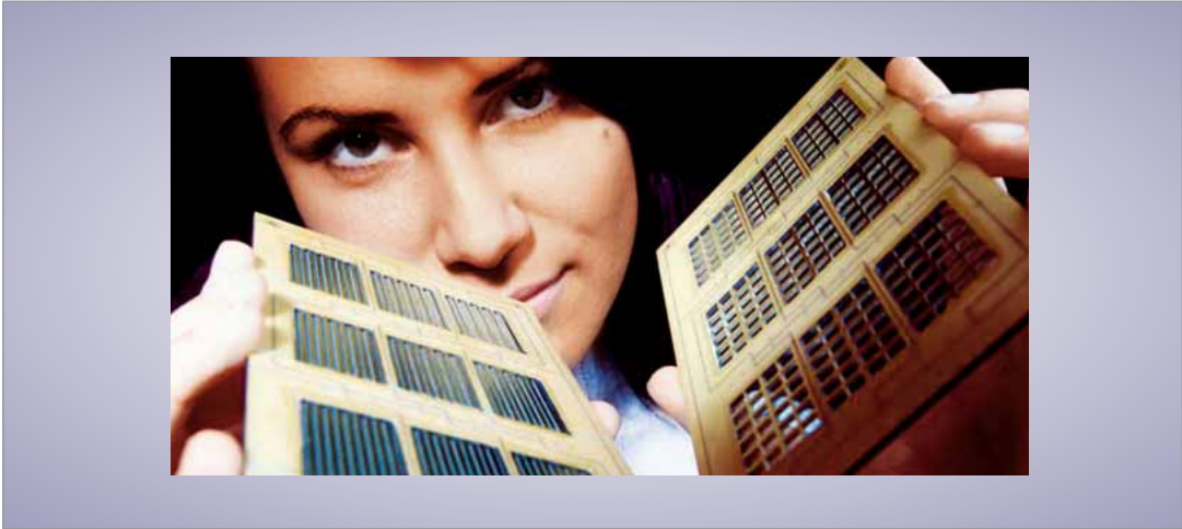
Abbildung 1 Planare, serien- verschaltete und selbstatmende Brenn- stoffzelle aus Leiter- platten-Material
