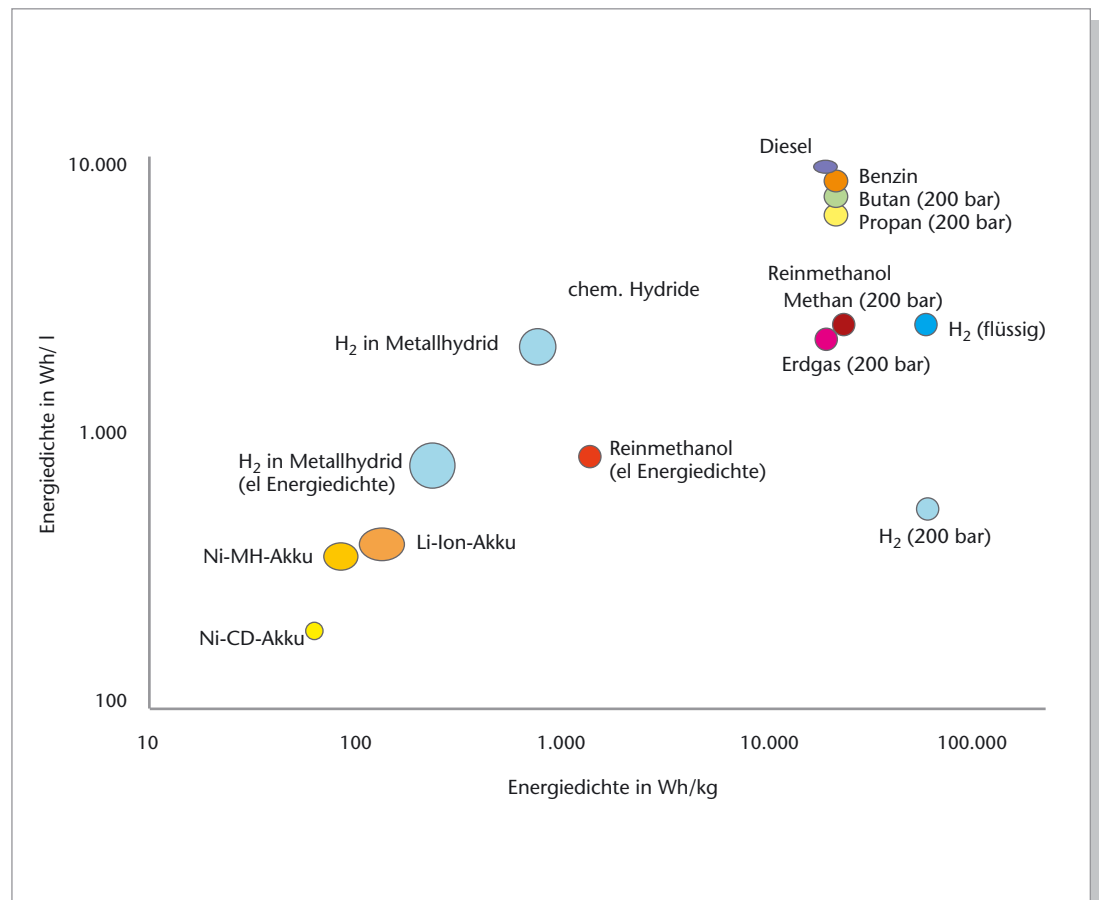
Abbildung 5 Energiedichten von Sekundärzellen und Brennstoffen. Die elektrische Energiedichte bei Wasserstoff bzw. Methanol wurde mit Systemwirkungsgraden von 35% (PEMFC) bzw. 20% (DMFC) angegeben. Quelle: Fraunhofer ISE
