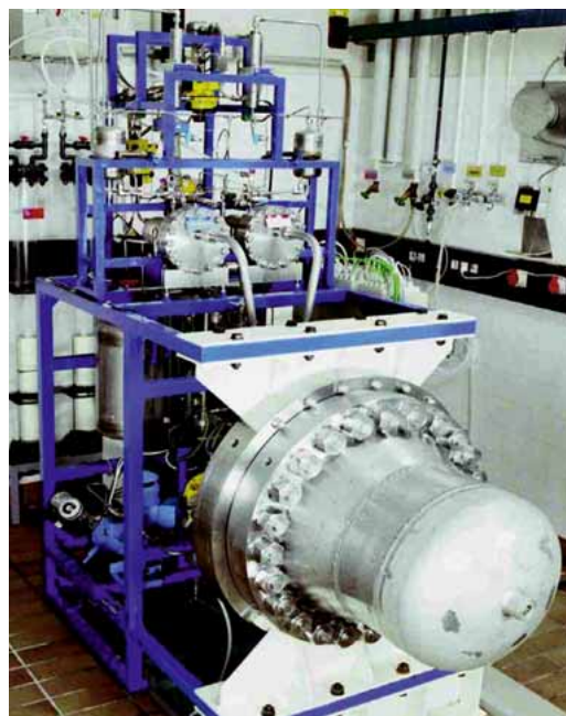
Abbildung 6 Alkalischer Druckelektrolyseur entwickelt im FZ Jülich: Betriebsdruck 120 bar, Betriebstemperatur 80°C, Anschlussleistung 5 kW el , 15 Einzelzellen, katalytisch aktivierte Nickelanoden (Co,Fe) und Nickelkathoden (C-Pt).
