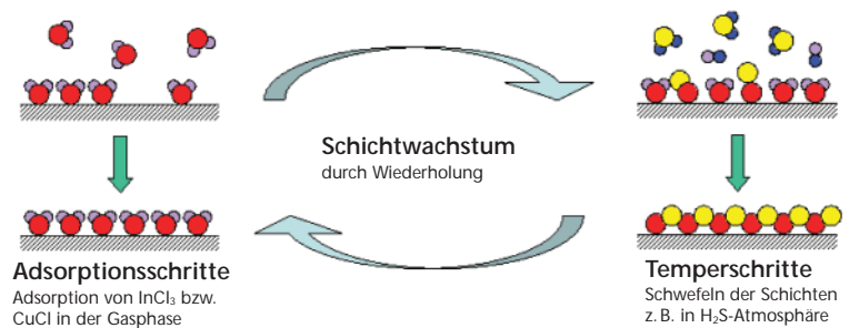
Abbildung 4 Prinzip der ALD (atomic layer deposition)
