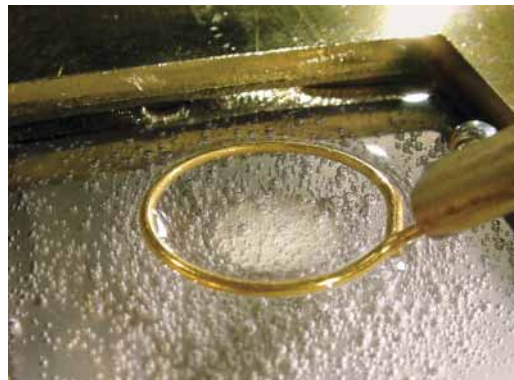
Abbildung 5 H 2 -Bläschenbildung bei Stromfluss (Metallsubstrat ohne Barriere)
