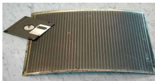
Abbildung 6 CIS-Solarmodul (20 cm x 30 cm), monolithisch verschaltet
