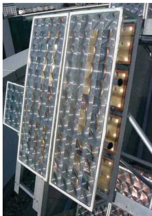
Abbildung 2b FLATCON™ Konzentratoren mit Testmodul
