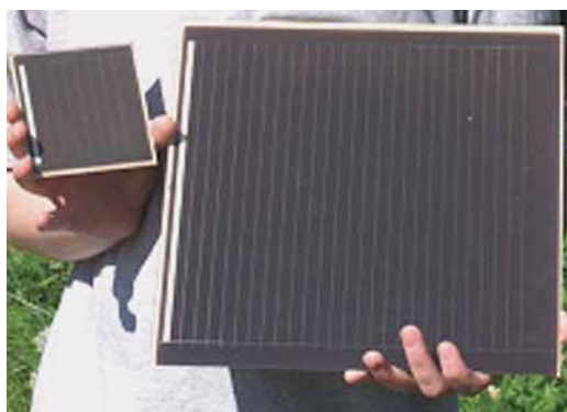
Abbildung 8 Zwei a-Si:H/μ-Si:H-Solarmodule vom FZ-Jülich
