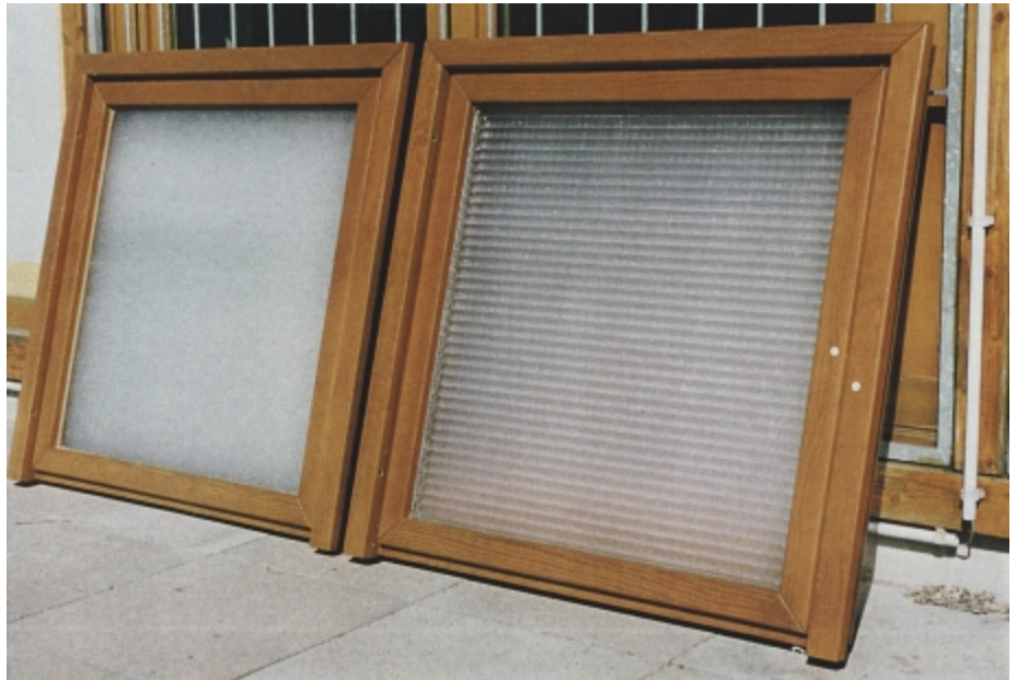
Abbildung 10: Transparentes Dämmelement mit Prismenscheibe sowie ein Referenzelement vor dem Einbau in die Südfassade eines ISFH-Versuchshauses
