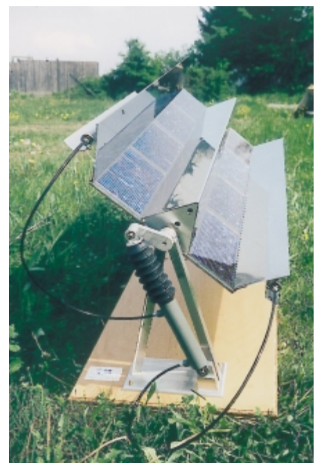
Abbildung 5: PV V-Trog Funktionsmodell mit einer Fläche von 0,5 m 2
